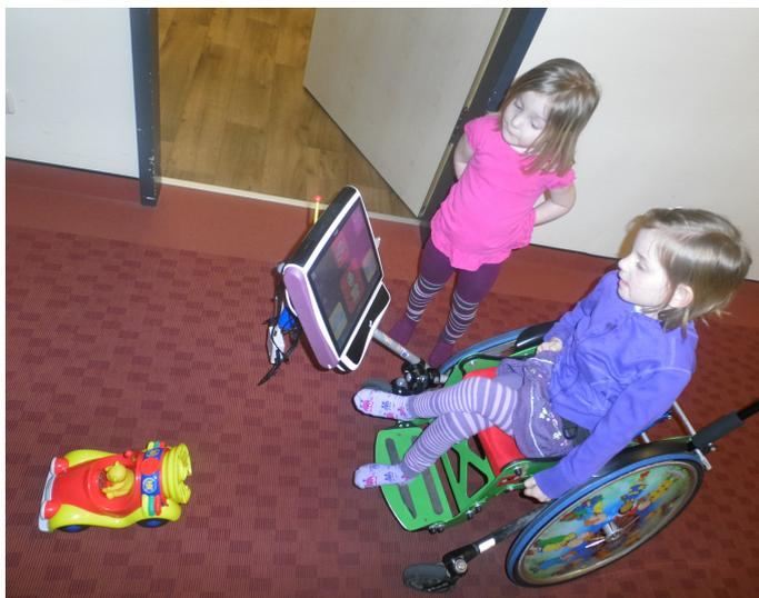
Ist es dem Nutzer nur schwer möglich einen Taster mit den Händen auszulösen, kann die BJ Toybox an den Tobii angeschlossen werden und ersetzt den Taster. Nun kann jedes Gerät mit den Augen geschaltet werden (an/aus, für eine bestimmte Zeit oder als kurzer Impuls z.B. für den Powerlink). Hier ist die adaptierte Fernbedienung des Autos an die Toybox angeschlossen. Vivien steuert das Auto mit den Augen.
